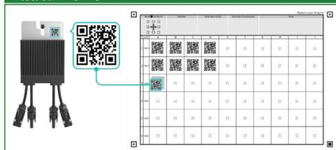
确定优化器安装位置后，将优化器上的 SN 标签撕下，根据现场实际布局情况，粘贴在物理布局模板上。
