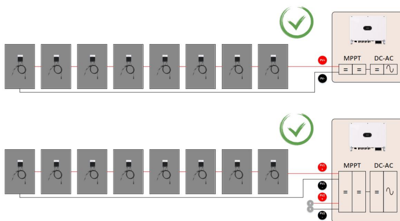
图 9 一路 MPPT 下安装一路组串，组件全部安装优化器
