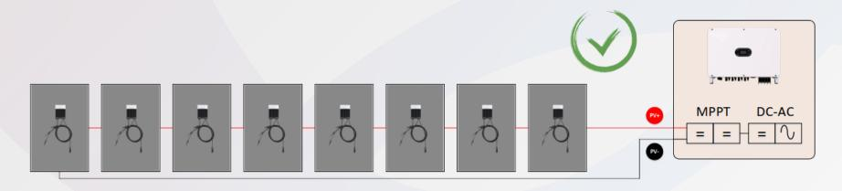
正确案例3:一路MPPT下多个PV输入,只接了1路PV输入,所有组件均接入优化器。
