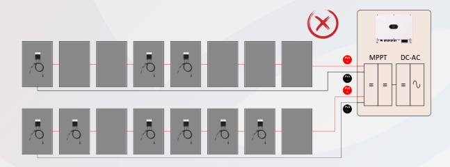
错误案例2:一路MPP下有多个PV输入,不同MPPT之间的组件数量一致,PV1没接优化器,PV2全接优化器。
