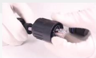
将网线穿过防水头
